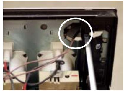
Les illustrations montrent la barre lumineuse en tant que composant séparé ainsi que les bornes électriques dans la perspective de l'intérieur de l'appareil, à gauche et à droite respectivement. La situation d'encastrage est dans le support du panneau de commande. Le panneau de commande doit être retiré pour pouvoir démonter la barre lumineuse.
