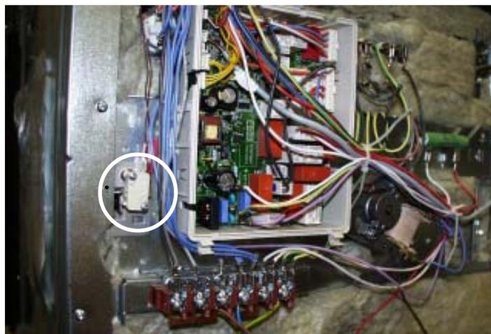
Les appareils dotés d'un système autonettoyant par pyrolyse sont équipés d'un microcommutateur. Ce micro commutateur se trouve sur le côté extérieur gauche de la plaque de composants. Ce n'est que pour des plaques de four suspendues, et non pour des grilles enfournables, qu'un microcommutateur permet d'interrompre un contact de commutation empêchant que la fonction de pyrolyse soit activée.
